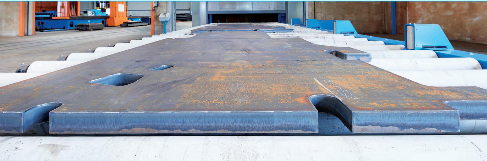
**Dicke 10 - 350 mm    Breite max. 4000 mm    Länge max. 12000 mm**
